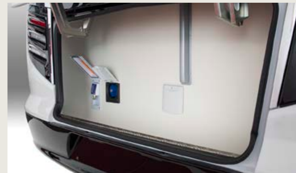
De opbergekast achterin is meer dan een standaard caravankofferbak. Hier zijn ook de stroom- en stadwateraansluitingen ondergebracht, waardoor de zijwanden vervaardigd zijn zonder openingen en koudebruggen.
