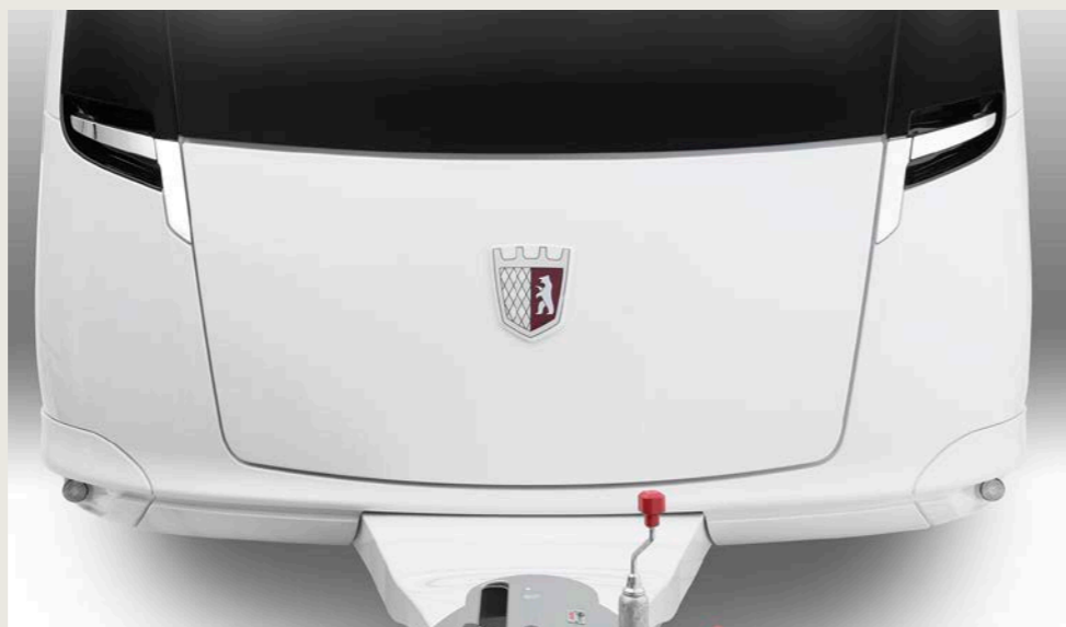
LFI-delen (Long Fiber Injection) aan de voor- en achterkant verhogen de stabiliteit van de opbouw, de aerodynamica en de isolatie.
