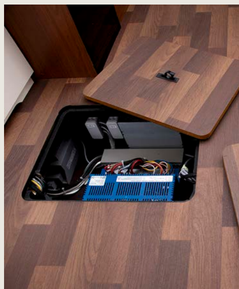
Het nieuwe bodemconcept brengt belangrijke technologie en verwarmde opbergruimte onder in de buurt van de as, wat een gunstig zwaartepunt oplevert.
