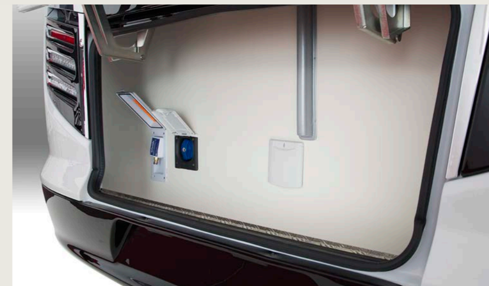
De opbergkast achterin is meer dan een standaard caravankofferbak. Hier zijn ook de stroom- en stadwataansluitingen ondergebracht, waardoor de zijwanden vervaardigd kunnen worden zonder openingen en koudebruggen.
