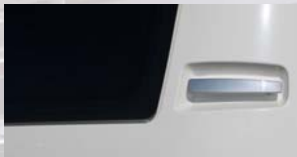
Voor- en achterraam vlak in wanden geïntegreerd
