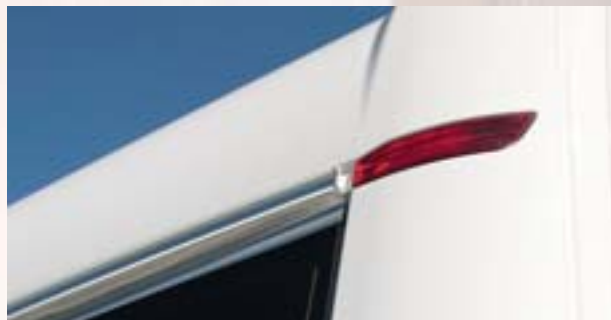
Gecombineerde LED achter- en remlichtunit voor veiligheid in het verkeer
