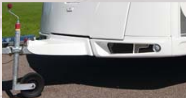
Hard neuswiel met gewichtsaanduiding voor het makkelijk controleren van de kogeldruk
