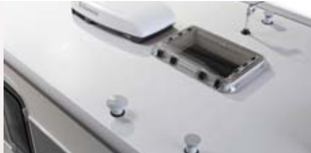
Polyester dak beschermt tegen hagel en steenslag
