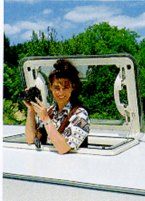
Das Hebe-Kippdach HEKI 1 (Serienausstattung im Diamant): Öffnungswinkel 90°, mit integriertem Insekten- und Verdunklungsrollo und höchsten Isolationswerten.
